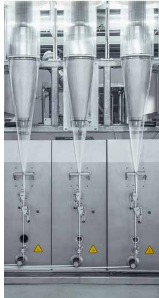
Kurulu Staple FORCE S 1100, 30 metre uzunluğunda, 12 metre genişliğindedir ve günde 15 tona kadar mümkün olan en eşit kalitede sahip delikli fiber üretir.
