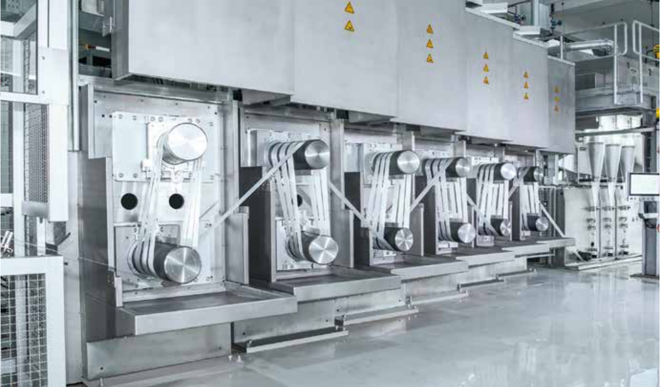
Staple FORCE S 1100, tek bir proses adımında ipi eğirir, çeker, kıvrır, keser ve balyalar. Burada elyaf, yüksek hızlı bir proseste galetler kullanılarak çekilir. Birbirinin üzerine yerleştirilen bir dizi galet, kendi başlığı ile ikili bir gerdirme oluşturur.
