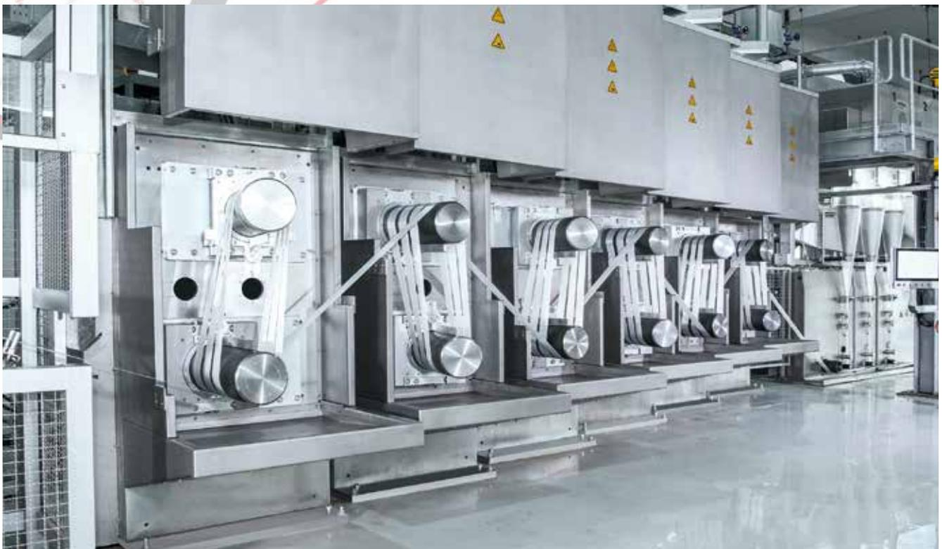
Staple FORCE S 1100的纺丝、牵伸、卷曲、切断和打包都在同一个工艺步骤中。在这里，使用辊对以高速工艺拉伸纤维束。辊对在位于彼此上方的罩盖中形成一个牵伸组合。
