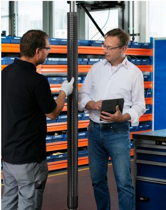
BALINIT ALTIMA ist die moderne Alternative zu den gängigen TiN- und TiCN-Produkten vor allem für großdimensionierte Räumwerkzeuge. / Foto: Oerlikon
