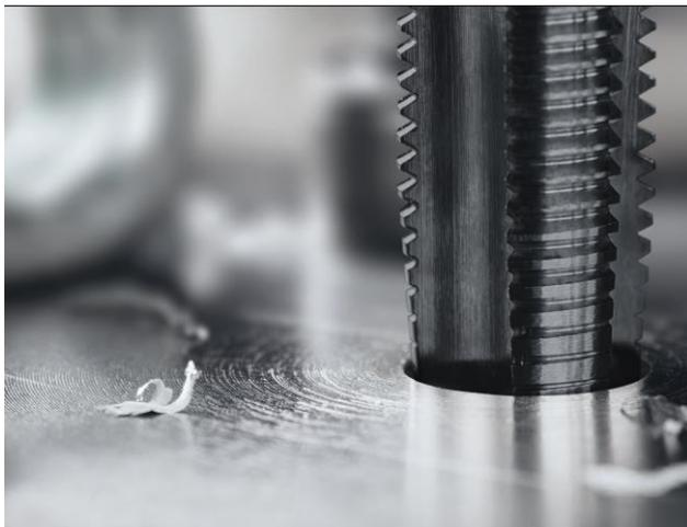
BALIQ ANTOS sorgt mit Glätte für minimale Reibung beim Gewinden und realisiert dadurch in Tests deutlich höhere Standzeiten gegenüber bisherigen Schichten. / Foto: Adobe Stock
