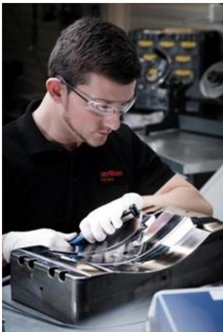
Von der Vorpolitur bis zum Finishing: Komplettservice rund ums Hochglanzpolieren von Spritzgießwerkzeugen. / Bild: Oerlikon Balzers
