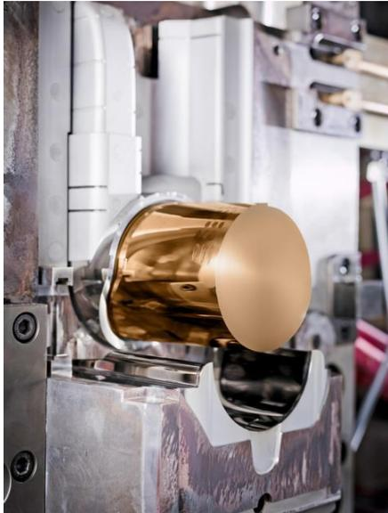
Beim Einsatz von BALITHERM® PRIMEFORM und der PVD-Beschichtung BALIQ® TINOS für die Fertigung von Feinstaubbehältern verlängerte sich das Wartungsintervall um das 10-Fache.
