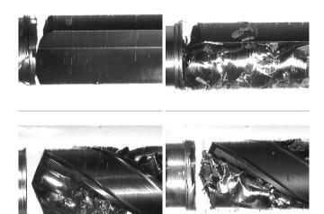
Testresultate im Bild: Der mit inShape und primeTreat behandelte Einlippenbohrer (oben li.) führte Späne gut ab, anders als der Referenzpartner rechts daneben. Das Wendelbohrer-Paar darunter zeigt ein ähnliches Bild. / Fotos: ISF Dortmund
