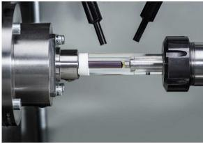
Bei allen Tests am ISF in Dortmund fand das Tiefbohren in blickdurchlässigen Acrylglasproben statt, um die Spanbildung exakt zu visualisieren. / Foto: Oerlikon Balzers
