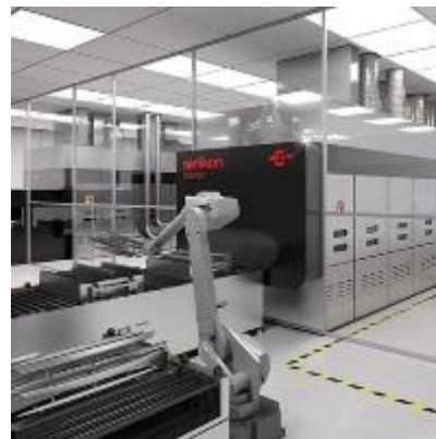
Das INUBIA I6-System metallisiert Kunststoffteile im Chrome-Look von Automobil-Interieurs und -Exterieurs auf der von Oerlikon Balzers entwickelten ePD-Technologie.
