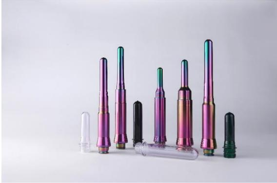
Die kohlenstoffbasierte Beschichtung BALINIT MAYURA eignet sich für alle Anwendungen, bei denen Abrieb und Anhaftungen kombiniert auftreten. Sie minimiert aufgrund ihrer herausragenden Härte und Glätte Materialanhaftungen auf NE-Spritzgusswerkzeugen. Gleichzeitig bleibt die Schärfe der Trennkanten durch die extrem dünne Schicht erhalten.
