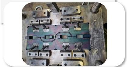
Ausschuss und Ausfallzeiten auf Null reduziert mit gleichbleibend hochwertigen Produkten: Prosperplast verwendet die BALINIT MOLDNA Schicht für das Spritzgießen von Blumentopffüßen (Grafik: Oerlikon Balzers)
