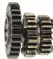
Abwälzende, hochbelastete Oberflächen, zum Beispiel in Zahnradgetrieben, schützt man am besten mit sorgfältig abgestimmten PVD-Beschichtungen. (Bild: Shutterstock)
