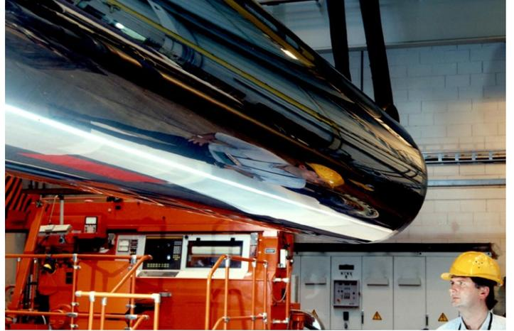
图23 – 超精抛光后的Metco™CAL 涂层
