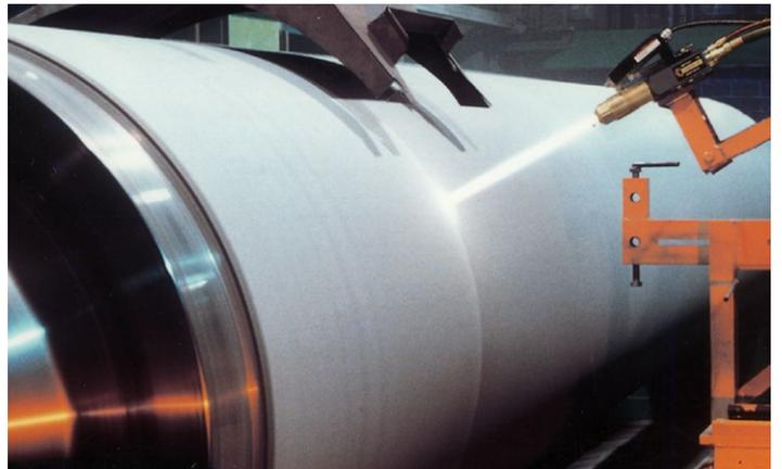
图22 – 沉没辊的高速火焰喷涂
