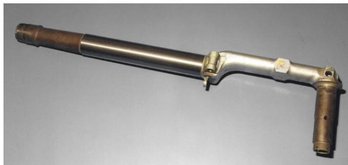
图14 - 表面碳化钨/镀铬涂层的F5“老虎”战斗机前起落架
