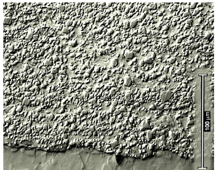
图11 - WC（CoCr）高速火焰喷涂涂层
