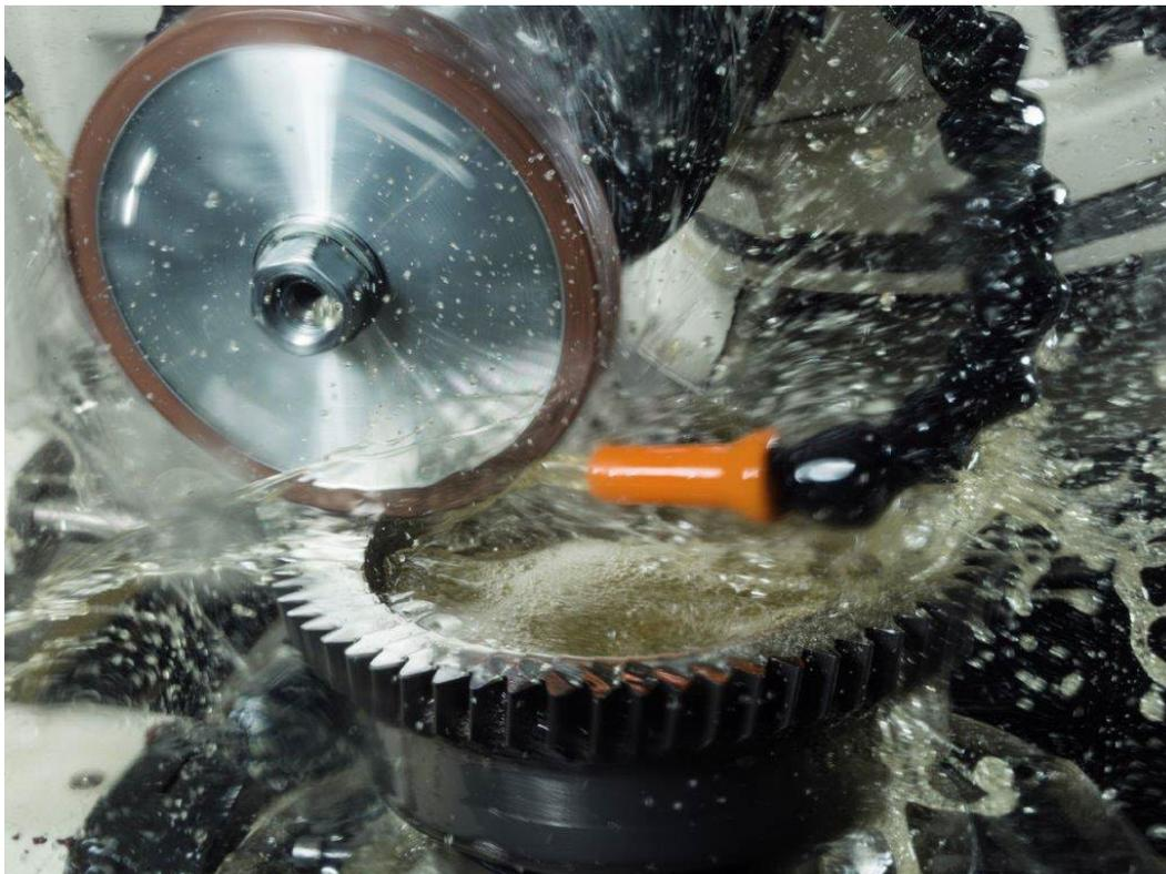
Dathan Verzahnungswerkzeuge bietet viel Know-how für das aufstrebende Verfahren des Wälzschälens, hier für das präzise Schärfen der Wälzschälräder. / Foto: Oerlikon Balzers
