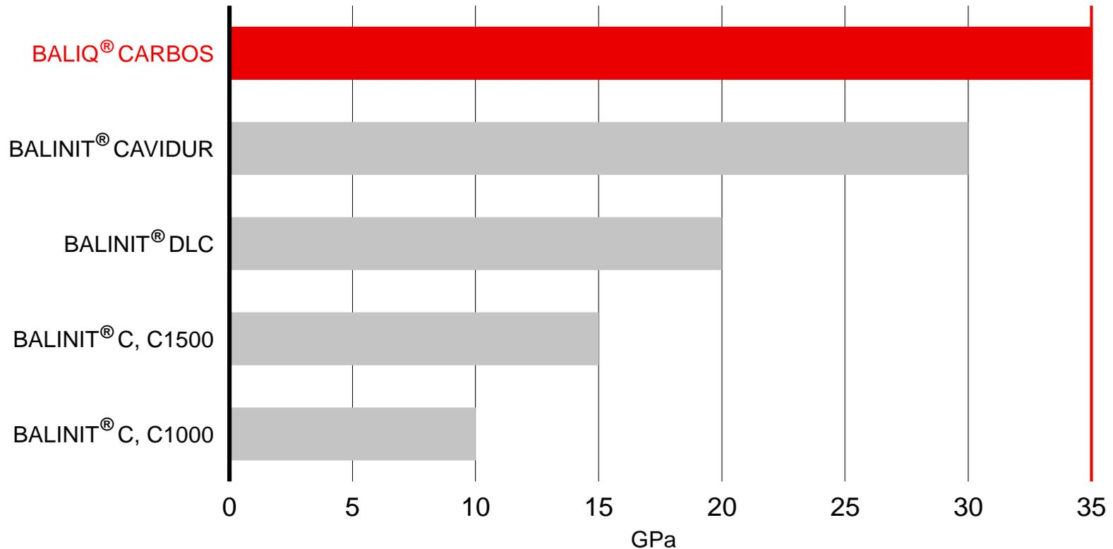
**BALIQ<sup>®</sup> CARBOS bietet einen höheren Härtegrad und deshalb verbesserte Abrasionsbeständigkeit im Vergleich zu Standard-DLC-Beschichtungen.**
