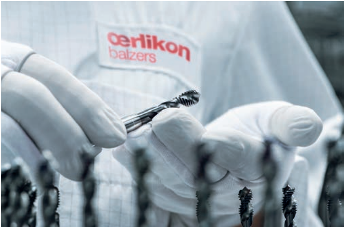
Hightech-Beschichtungen schützen Werkzeuge vor Verschleiss und Abrieb.
