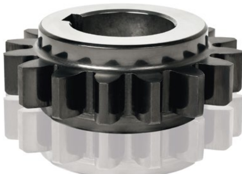
Bild 3: Das Ritzel aus Test 4 mit Gleitschliff und Kohlenstoffbeschichtung
