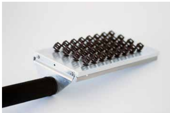
Die von Cubicure entwickelten Photopolymere sind in ihren Eigenschaften technischen Thermoplasten ähnlich .
