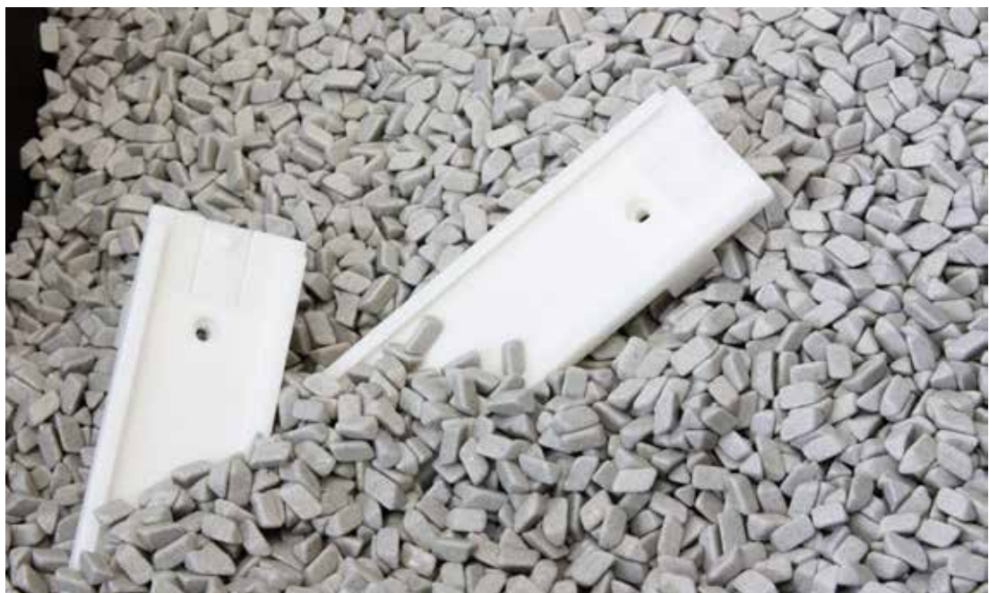
Glattschleifen eines Lasersinter-Bauteils , hier eines Tubenhalters in einem Förder-system.
