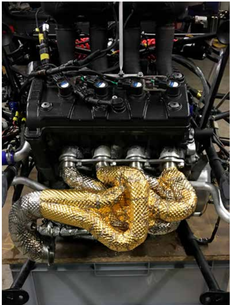
Die Abgasanlage an ihrem Einsatzort.
