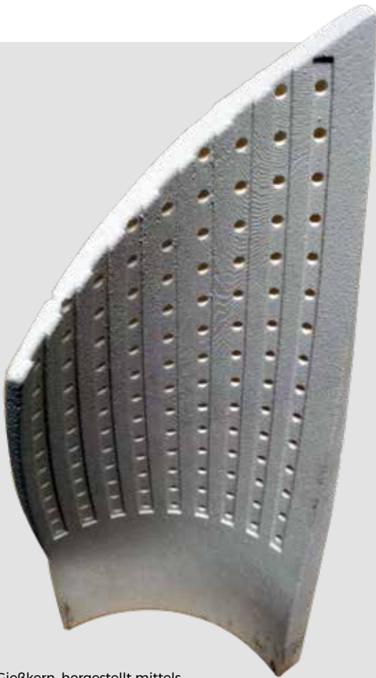
Cießkern, hergestellt mittels Binder Jetting . (Bild: WZR)
