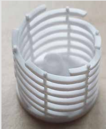
links Designobjekt, hergestellt mittels Material Extrusion (Bild: WZR)
