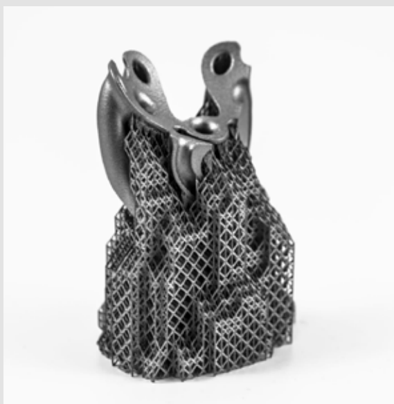
Offene Supportstrukturen wie von Materialise e-Stage for Metal erleichtern die Pulverrückgewinnung.
