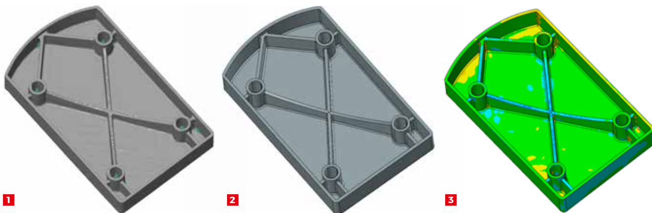
Nach dem Scannen (Bild 1) wird das Teil mit der CAD-Geometrie (Bild 2) verglichen und die Abweichungen farblich gekennzeichnet (Bild 3).
