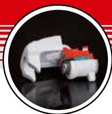
BREMSSATTEL SLA GEFINISHED UND LACKIERT
