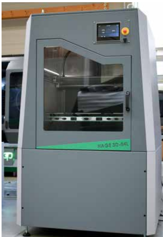
84L - Industriedrucker mit Dualdrucktechnologie. Ein Freihub der inaktiven Düse sorgt für eine saubere Materialtrennung.
