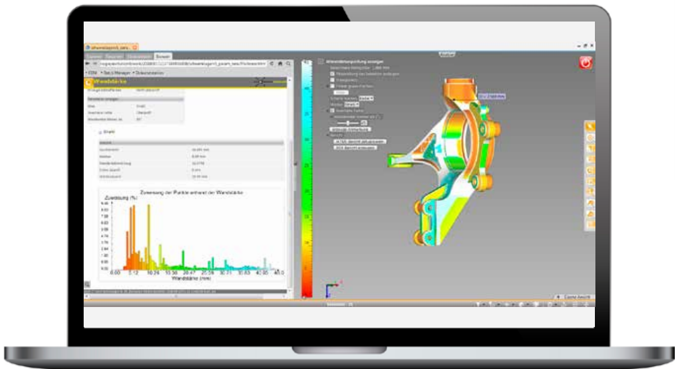
Beispiel einer Wanddickenanalyse mithilfe des Partfinders.
