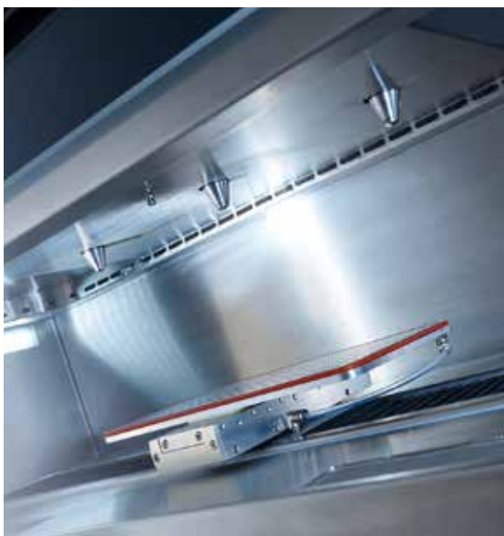
Der Bauraum des Freeformers 300-3X mit einer Größe von 234 x 134 x 200 Millimetern .
