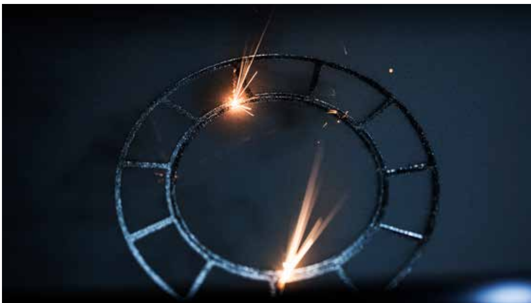
Zwei Laser erhöhen beim SLM nicht nur die Baugeschwindigkeit, sondern auch die Qualität des Bauteils.
