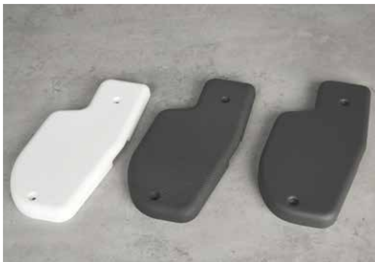
Die Ersatzteile von Daimler: im Bild links das SLS-Rohbauteil, in der Mitte der mit DyeMansion-Technologie behandelte SLS-Bauteil in Daimler EvoGrey und rechts das im Spritzguss gefertigte Ersatzteil.
