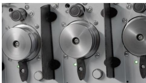
**Bildunterschrift 2:** Smart Godets - die neue Technologie der Einzelumrichter-gesteuerte Galetten optimiert den Betriebspunkt jeder Galette und verbessert damit den Energieverbrauch erheblich.
