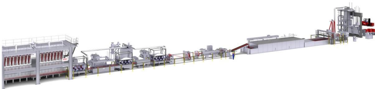
**Bildunterschrift:** Im PP Prozess werden bevorzugt einstufige Stapelfaseranlagen eingesetzt.
