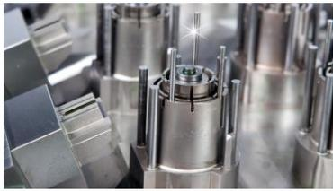
Bild 8: BALINIT MOLDNA: Die neue Beschichtung für Spritzguss und Extrusion von gefüllten Polymeren.
