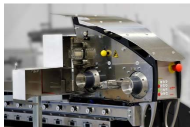
WINGS 全封闭的牵伸区确保了加工过程的清洁。
