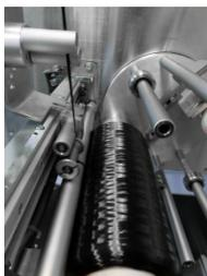
Der zweifädige Kohlefaserwickler WinTrax A-2cop produziert Spulen mit perfektem Spulenaufbau und identischer Lauf­länge.
