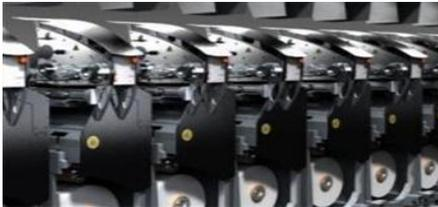
Spinnanlagen, Schlüsselkomponenten und Engineering Service zur Herstellung von Pre-oriented Yarn (POY)
