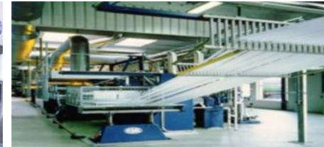
Spinnanlagen, Schlüsselkomponenten und Engineering Service zur Herstellung synthetischer Stapelfasern
