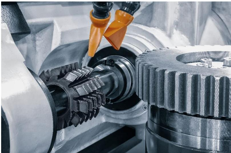
O BALINIT ALCRONA EVO já demonstrou as suas capacidades em testes conduzidos por um fornecedor automóvel Tier 1 para fresagem de engrenagens, aumentando a vida útil da ferramenta em mais de 40%. Imagem: AdobeStock
