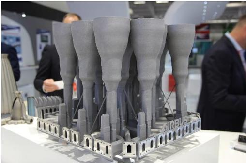
Oerlikon AM 은 Airbus 통신용 위성의 일부인 알루미늄 안테나 클러스터와 같은 금속 부품의 적층 가공을 위한 솔루션을 제공합니다. / 이미지 출처: Oerlikon
