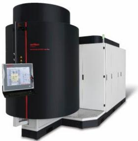
올리콘의 METAPLAS.DOMINO 시스템을 위한 새로운 HMI(Human Machine Interface) 솔루션은 코팅 공정 중에 실시간 모니터링과 시각화를 가능하게 하여 효율성을 증대시킵니다. / 이미지 출처: Oerlikon
