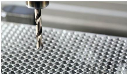
Ein unbeschichteter Bohrer schafft 28 Löcher, mit der Schicht BALINIT PERTURA sind es über 4.500 (Foto). Diese 160-fache Lebensdauerverlängerung spart 13,7 kg Hartmetall und das Äquivalent von 75 Buchen, die rund 935 kg CO<sub>2</sub> pro Jahr absorbieren, ein. Foto: Oerlikon
