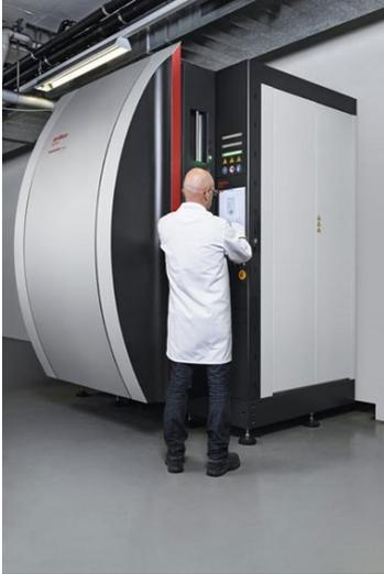
Der Ressourceneinsatz bei der PVD-Beschichtung in solchen Anlagen beträgt nur etwa 10 Prozent im Vergleich zur Herstellung eines Hartmetallwerkzeugs. Foto: Oerlikon
