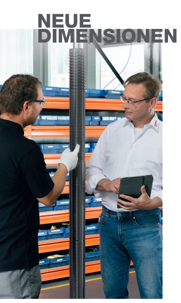
Die Produktentwicklung geht auf die Zielgerade: Die Experten von Oerlikon Balzers haben eine neue Beschichtung für Räumnadeln auf AlTiN-Basis entwickelt. Tests mit einem deutschen Automobilhersteller bestätigten aber bereits, dass der Newcomer neue Leistungsdimensionen eröffnet. So räumte er mit den bisherigen Standzeit-Schwankungen auf und steigerte die Bauteilproduktion um bis zu 100 Prozent.
