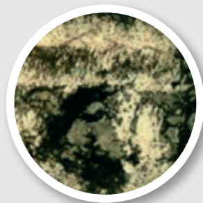
摺動距離 150メートル後の 窒化リングの摩擦跡 (30x)は深いガーリング
