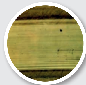
摺動距離 2,000メートル後の BALINIT® C がコーティング されたリングの摩擦跡 (30x)は わずかなランニング・イン (摩擦深さ約0.2μm)
