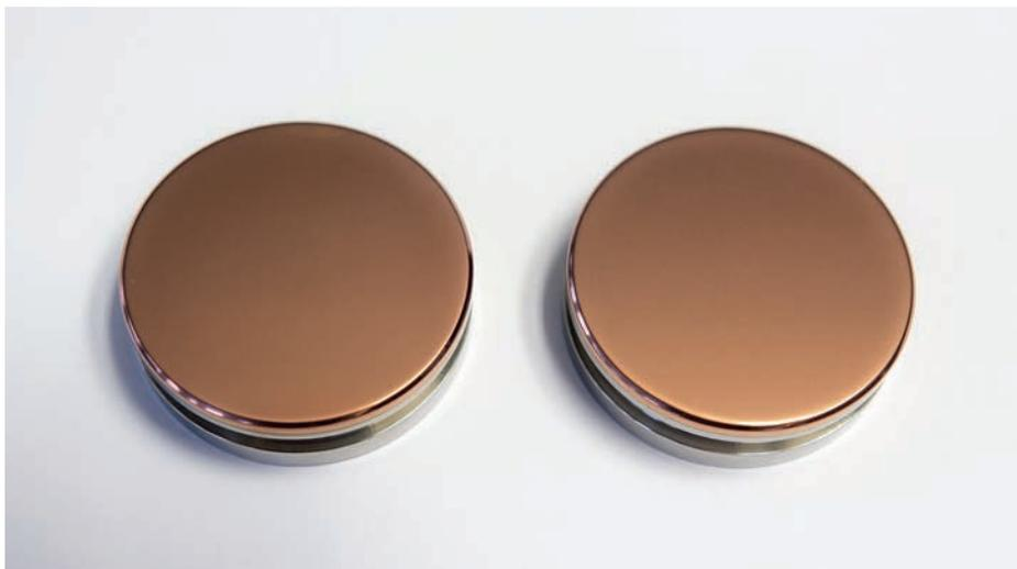
■ Die Beschichtung zeigt eine stabile Farbe ( $\Delta E=0.7$ ) auch 34 Tagen nach dem Eintauchen in eine Lösung mit 25% NaCl ohne Anzeichen von lokaler Korrosion. Die Korrosionsbeständigkeit schützt auch vor Einflüssen durch Mundhygieneartikel und Speichel.
